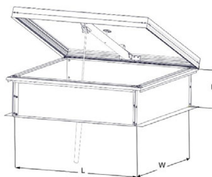
Rysunek 2. Świetlik SRD-1-T z funkcją przewietrzania.
