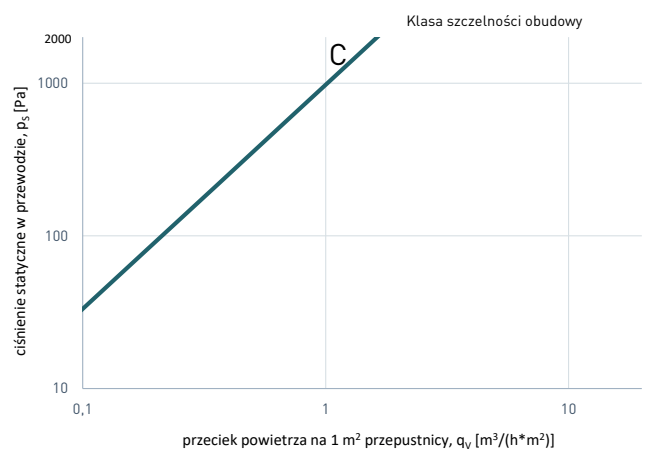
Wykres 3. Przecieki powietrza przez obudowę przepustnicy PW3S (pełne zamknięcie).
