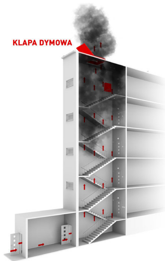
Rysunek 1. System ZODIC-G z kompensacją powietrza przez automatyczne otwarcie drzwi do klatki na parterze budynku.
