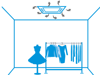
Rozkład powietrza z zabrudzonym filtrem
